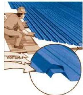
espaçados no máximo a cada 500 mm. Durante a montagem, retire as limalhas de furação e corte da superfície da cobertura. As **limalhas quentes grudam na película da tinta e enferrujam rapidamente**, facilitando o processo de corrosão. Para maior segurança no canteiro, adote o **método de tábuas apoiadas**, no mínimo em três terças. Assim, o pessoal da montagem desloca-se em segurança. Quando o caimento for grande, devem-se amarrar as tábuas às terças e pregar travessas.
